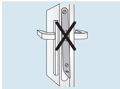
Si une serrure fait apparaître des signes évidents d'effraction, celle-ci doit impérativement être remplacée
