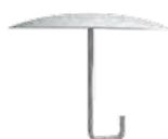
Capuchon d'acier avec ancrage béton
