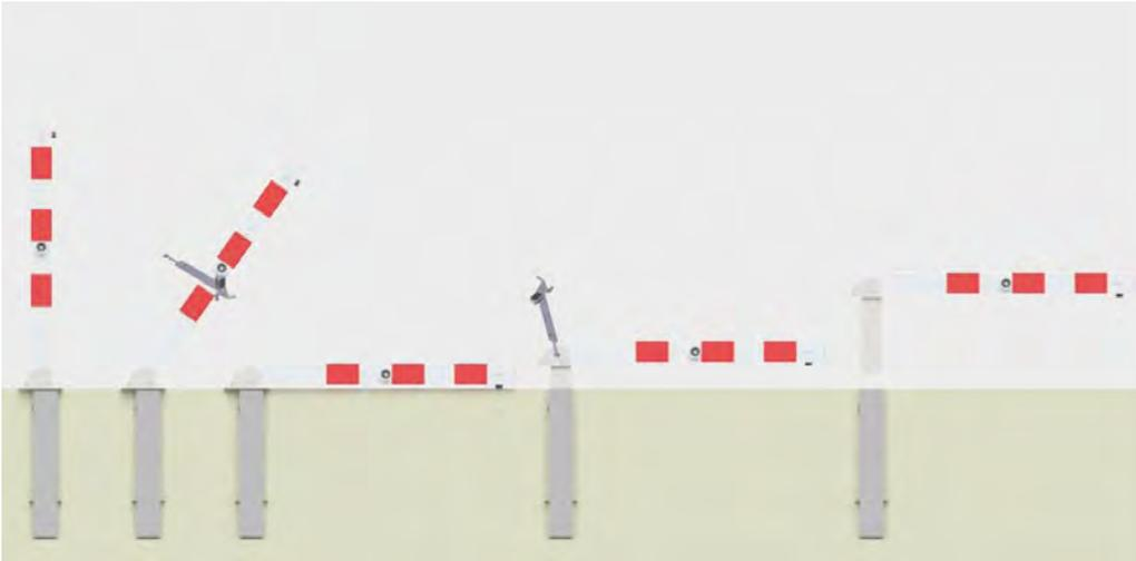
Si nécessaire, les poteaux de dissuasion rabattables peuvent également être utilisés rabattables + amovibles. La clé universelle réf. 18.470.40 est nécessaire dans tous les cas de figure (à commander en même temps).
