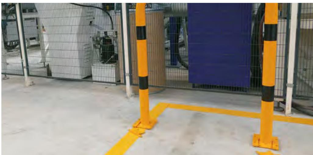
Pour ouverture ou fermeture temporaire de voies d'accès l'arceau est avec une double platine, l'une soudée à l'embase de l'arceau, l'autre est chevillée au sol. Les deux platines sont insérées l'une dans l'autre et verrouillées avec une vis à six pans.
