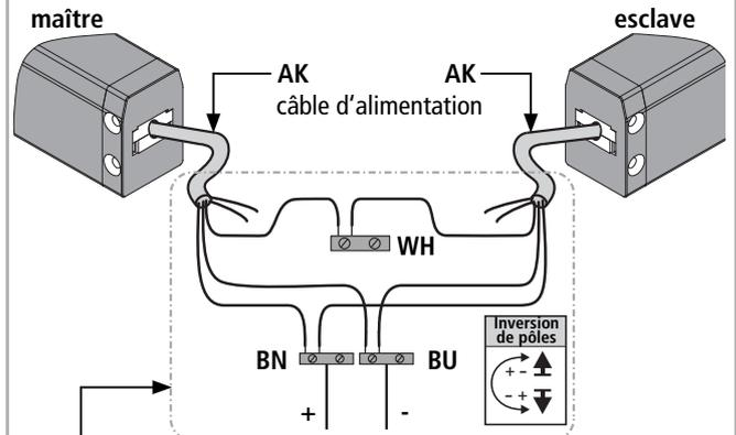
Prise de raccordement, fournie par le client      Alimentation 24 V DC de la centrale de commande
