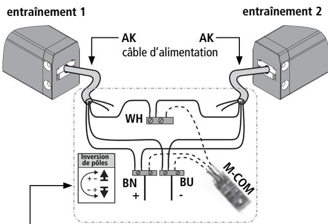
Prise de raccordement, fournie par le client      Alimentation 24 V DC de la centrale de commande
