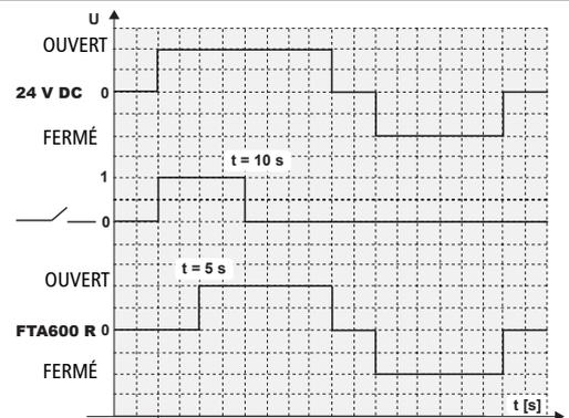
Après la mise sous tension le contact de verrouillage de la porte est activé pendant 10 secondes. Avec un délai d'environ 5 secondes le bras d'entraînement de l'entraînement de bras rétractables FTA600 R se met en mouvement et s'ouvre jusqu'à un angle de max. 93°. Lors de la fermeture, le contact de verrouillage de la porte n'est pas actionné.
