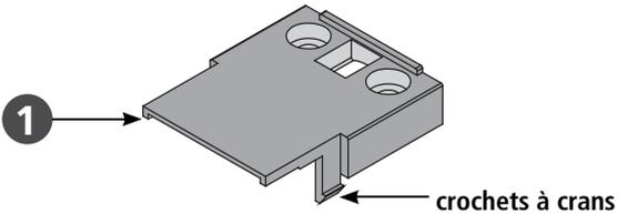
■ En dessous du boîtier ③ de la prise se trouvent deux ouvertures qui permettent de débloquent le crochet à crans.
