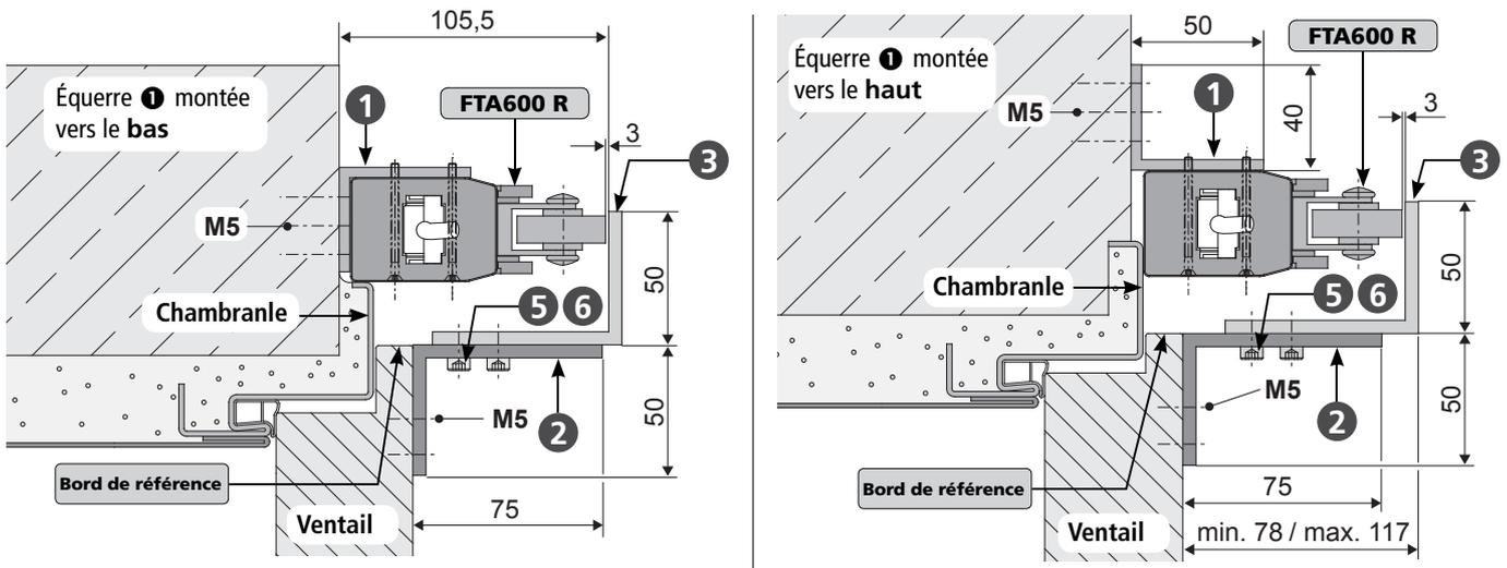
Les dimensions pour le montage dépendent du degré d'ouverture „ $\alpha \sim 90^\circ$ “, du renversement de battant „FÜ“ et de la dimension de l'axe des paumelles „B“
