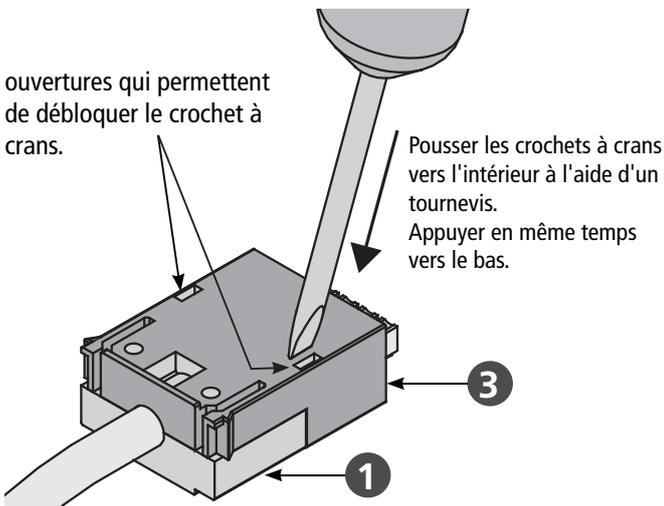
ouvertures qui permettent de débloquent le crochet à crans.
