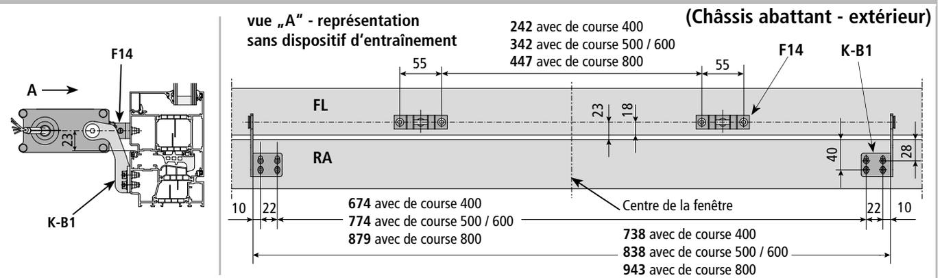
Schema de perçage pour consoles K-B1 et support de vantail F38 à la Wing 105D (RAICO)
