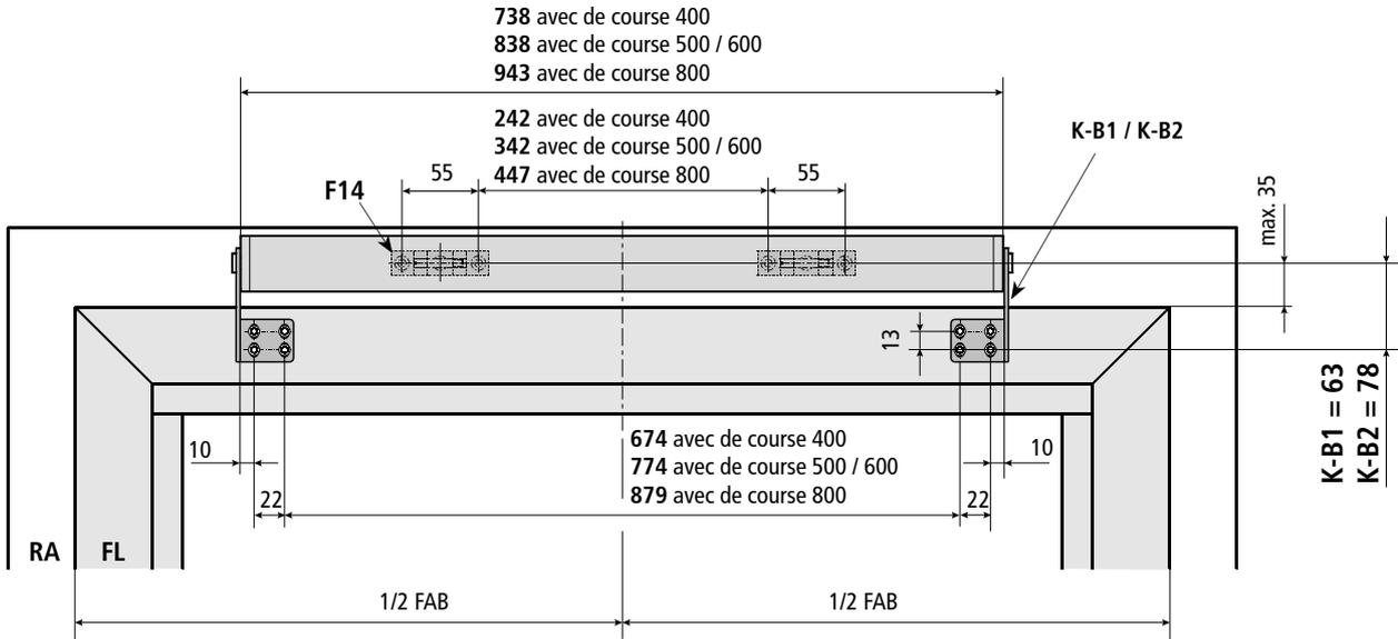
**Schéma de perçage pour consoles K-C1 / K-E1 et support de vantail F14**
