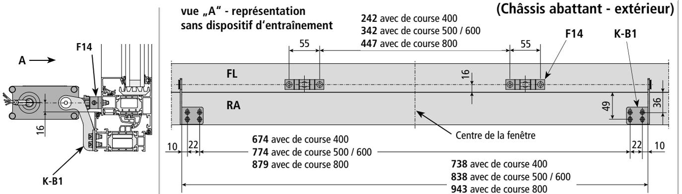
Schema de perçage pour consoles K-B1 et support de vantail F14 à la Wicline 75evo (WICONA)
