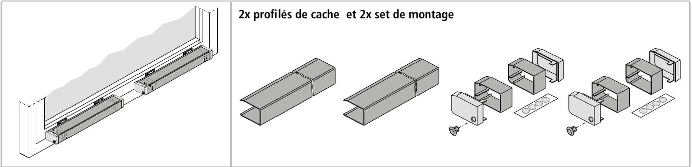
**Variante 3** Cache variable (p.ex. sur toute la largeur de la fenêtre) consoles visibles en partie
