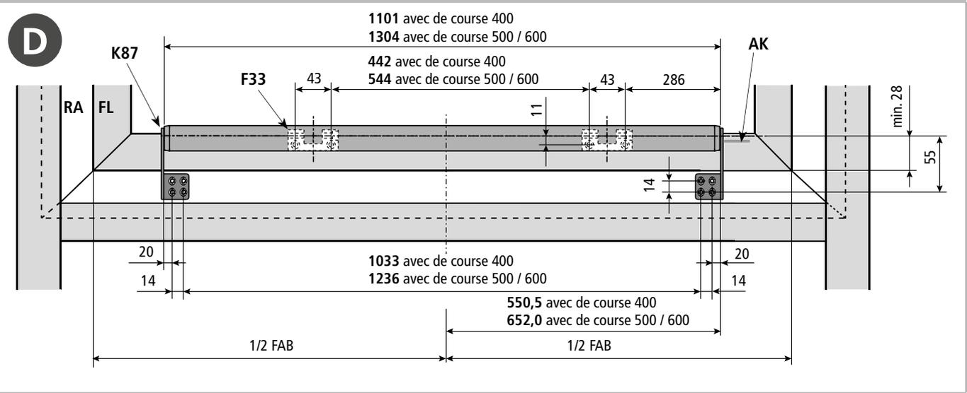
Schéma de perçage pour consoles K-D1 (K-C1 et support de vantail F73) (Châssis basculant - intérieure)
