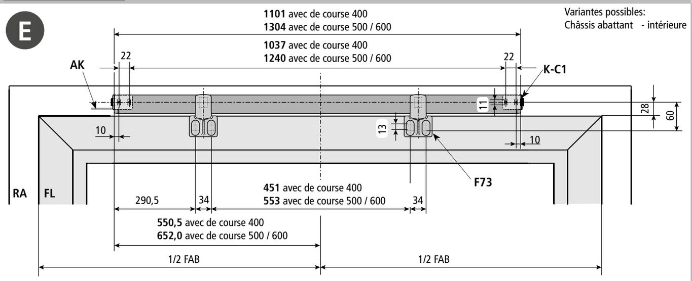
Schéma de perçage pour consoles K-F (et support de vantail F14) (Châssis basculant - intérieure)
