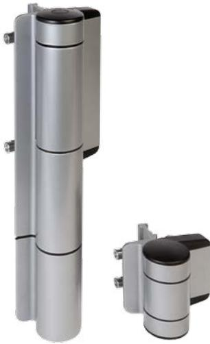
Charnière et ferme-porte hydraulique en un. Charnière à fermeture automatique qui ouvre avec souplesse et qui ferme automatiquement les portes jusqu'à 150 kg, avec frein hydraulique breveté insensible aux variations de températures. La force, la vitesse et l'à-coup final sont réglables.
