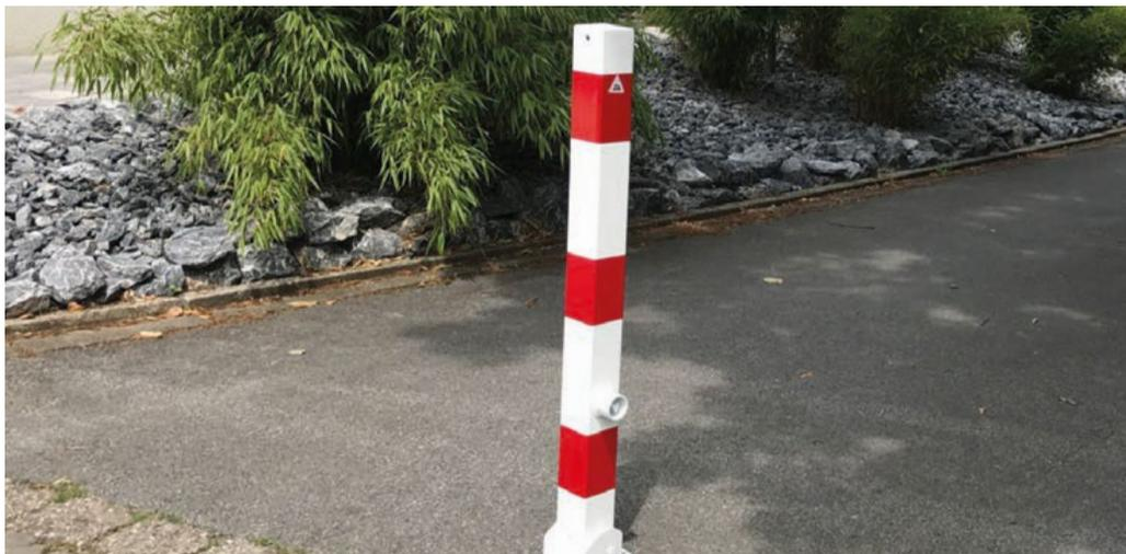
Un poteau de barrage pour une sollicitation sévère au quotidien. Platine massive à charnière, protégée contre la corrosion (galvanisée à chaud), avec boulon charnière solide Ø 16 mm et fixation robuste résistant à la déchirure. La fermeture à ressort plat ne nécessitant aucun entretien peut, à tout moment, être ouverte facilement et rapidement à l'aide d'une clé triangulaire DIN.
