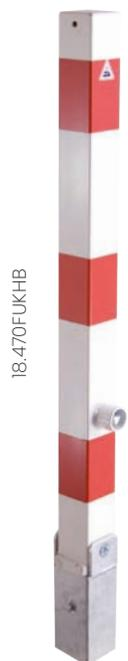
**RABATTABLE, AVEC BLOCAGE TRIANGULAIRE** suivant DIN 3223, avec **mécanisme de levage et de bascule**, avec ressort plat, verrouillage à encliquetage automatique, manchon de sol incl.
