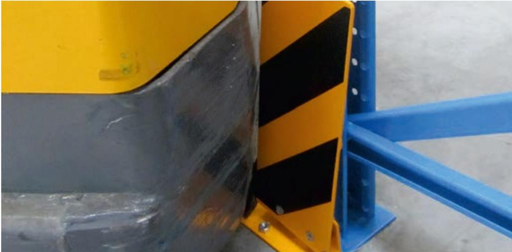
Pour sécuriser des structures de rayonnages. La nouvelle protection anticollision peut être inclinée jusqu'à 15°. Ceci permet d'amortir les chocs occasionnés par les chariots élévateurs ou d'autres véhicules et empêche ainsi l'arrachement ou l'endommagement des fixations par vissage/ chevillage du sol en béton (poussée jusqu'à 400 Nm).
