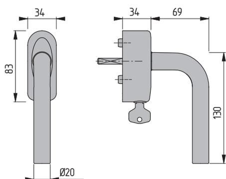
**Poignée de fenêtre WSS modèle 109, verrouillable**
