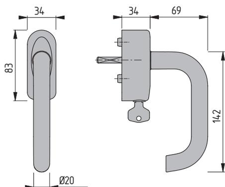
**Poignée de fenêtre WSS modèle 108, verrouillable**
