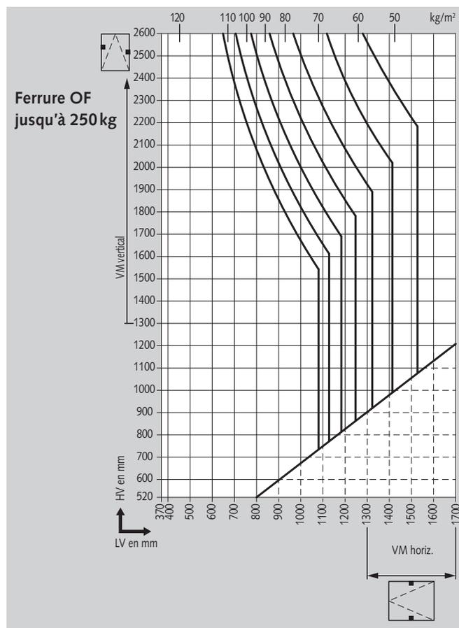
**Ferrures basculantes :** Poids de vantail de 200 kg max. Verrouillages supplémentaires semblables aux ferrures OF à partir de 1.300 mm de largeur et de hauteur de vantail.
