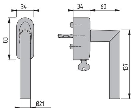
**Poignée de fenêtre WSS modèle 110, verrouillable**
