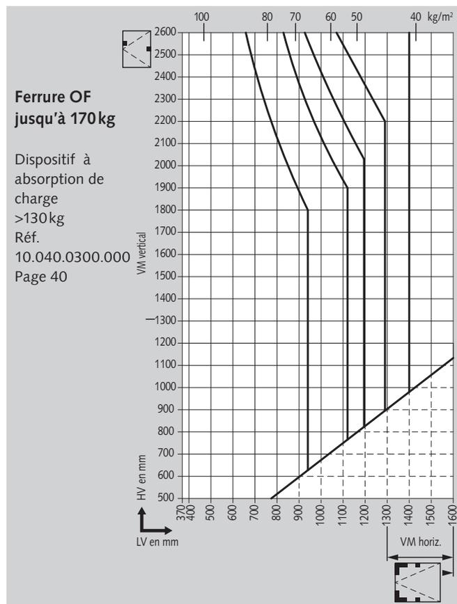
**Ferrures basculantes :** Poids de vantail de 130 kg max. Verrouillages supplémentaires semblables aux ferrures OF à partir de 1.300 mm de largeur et de hauteur de vantail.
