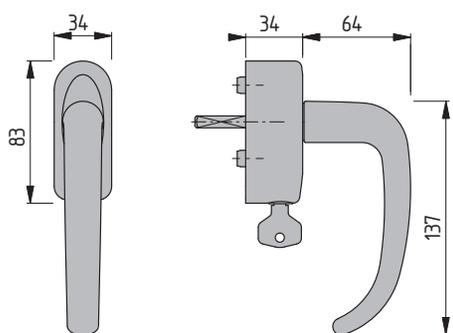
**Poignée de fenêtre WSS modèle 116, verrouillable**
