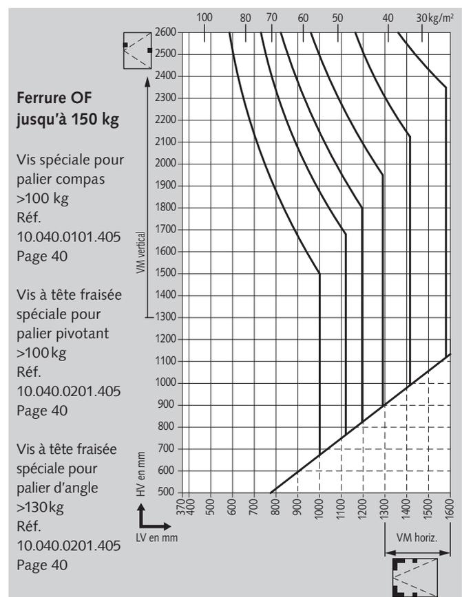
**Ferrures basculantes :** Poids de vantail de 150 kg max. Verrouillages supplémentaires semblables aux ferrures OF à partir de 1.300 mm de largeur et de hauteur de vantail.
