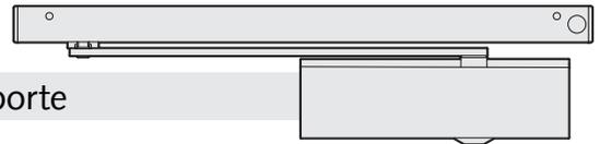
Les ferme-porte assurent la fermeture sécurisée et autonome d'une porte et sont adaptées à des portes de butée à 1 vantail de 1 100 mm de largeur au maximum. Les ferme-porte disposent d'un cran d'arrêt réglable en continu entre 80° et 130°. La force de fermeture est réglable en continu et correspond à la norme DIN EN 1154.
