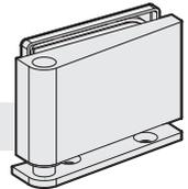
Les paumelles d'angle avec palier au sol et au plafond à visser sont adaptées aux portes en verre de 8 à 12 mm d'épaisseur et présentent un poids maximal de 80kg. Les paumelles d'angle pour portes peuvent être utilisées à gauche et à droite.
