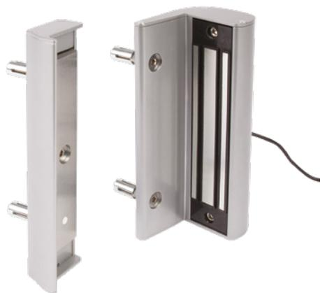
Ventouse électromagnétique à visser sans poignées. Disponible en 2 versions. La MAGMAG3000 avec 300 kg de force de rétention et la MAGMAG6000 avec 600 kg de force. Le coffre en aluminium thermolaqué, prévu avec des fixations uniques Quick-Fix, permet une fixation simple et rapide. Plus de perte de temps avec les soudures et les découpes; uniquement 5 trous pour fixer la ventouse. Le revêtement protecteur à deux couches garantit une utilisation en extérieur sans entretien pour des années.
