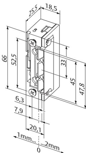
Gâche électrique à émission de courant Profix 2 - 10-24 volts V AC/DC avec diode de protection bipolaire pour dispositifs de contrôle d'accès
