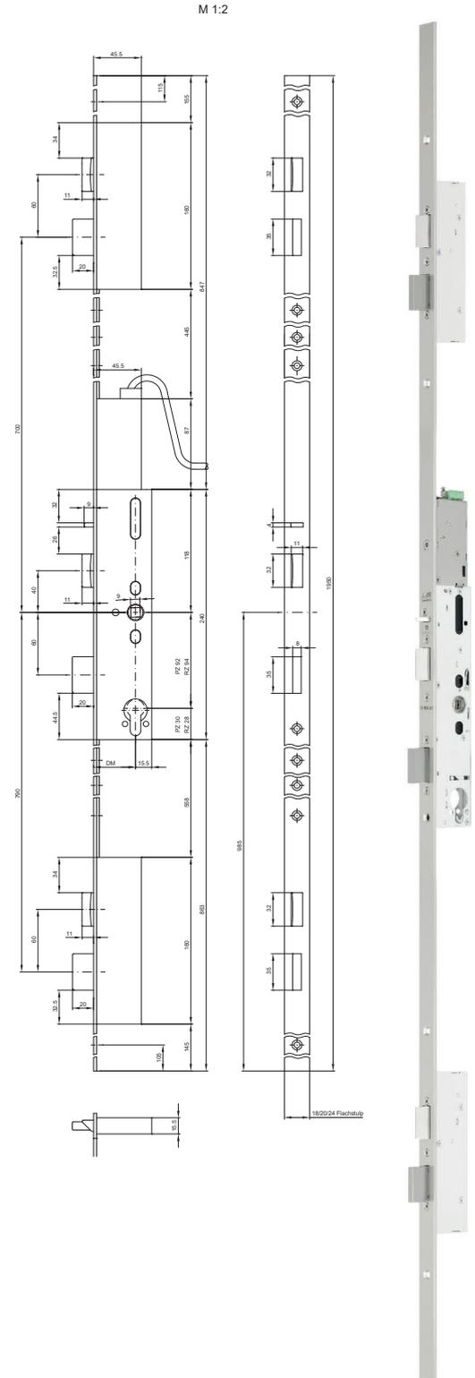
DM / Existe également avec d'autre distance au canon en mm 30 / 35 / 40 / 60 / 70 / 80
