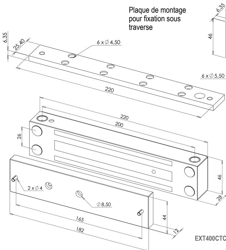
Plaque de montage pour fixation sur porte tirante, à utiliser avec un kit Z
