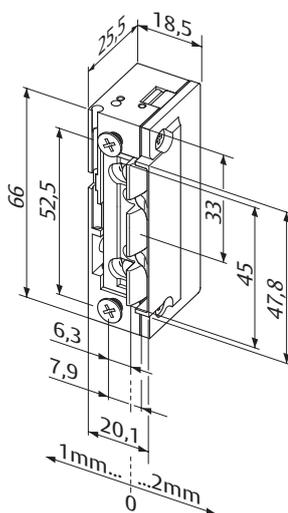
Gâche électrique à émission de courant Profix 2 - 22-42 volts V AC/DC avec diode de protection bipolaire pour dispositifs de contrôle d'accès
