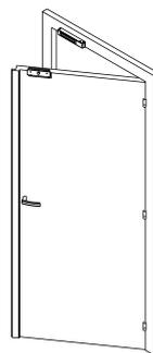
Montage sur porte affleurante avec kit Z et équerre en L
