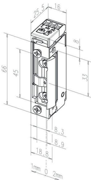
Modèle avec diode de protection bipolaire pour les dispositifs de contrôle d'accès. Contact de signalisation en tant que contact inverseur sans potentiel. Ce dernier est actionné par le demi-tour de la serrure.
