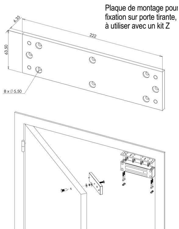
Plaque de montage pour fixation sur porte tirante, à utiliser avec un kit Z
