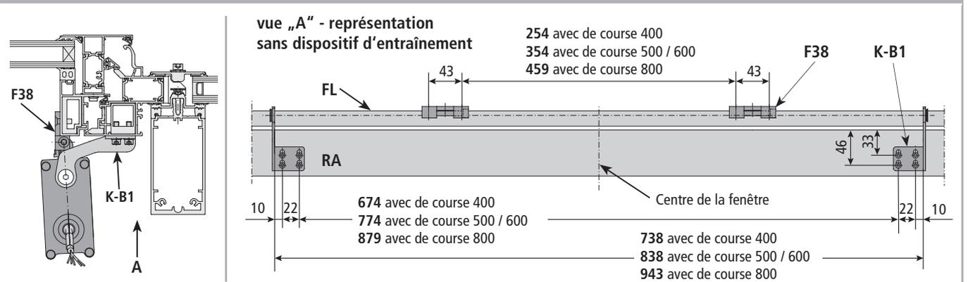
Schema de perçage pour consoles K-E1 et support de vantail F16-1 à la AWS 57 RO (SCHÜCO)
