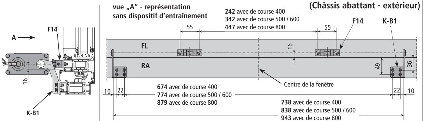
Schema de perçage pour consoles K-B1 et support de vantail F14 à la Wiclina 75evo (WICONA)
