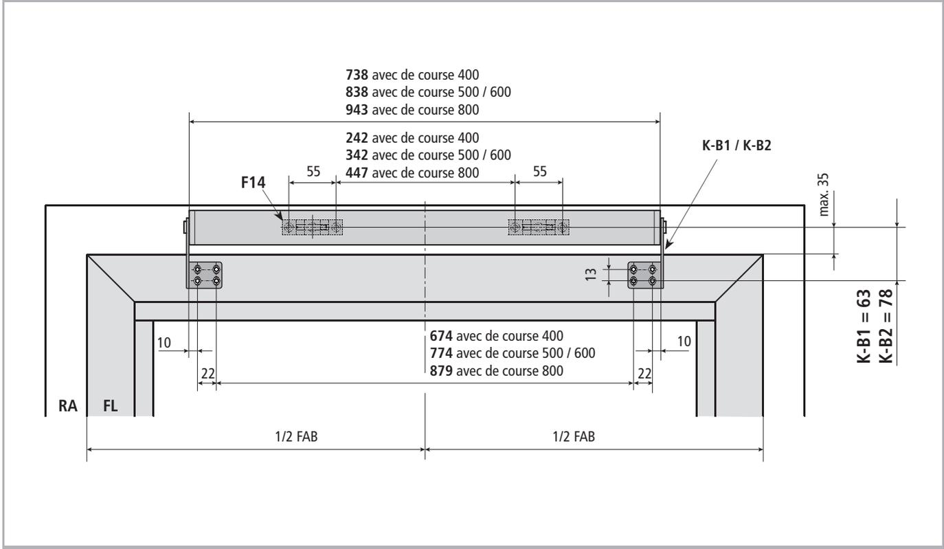
**Schéma de perçage pour consoles K-C1 / K-E1 et support de vantail F14**
