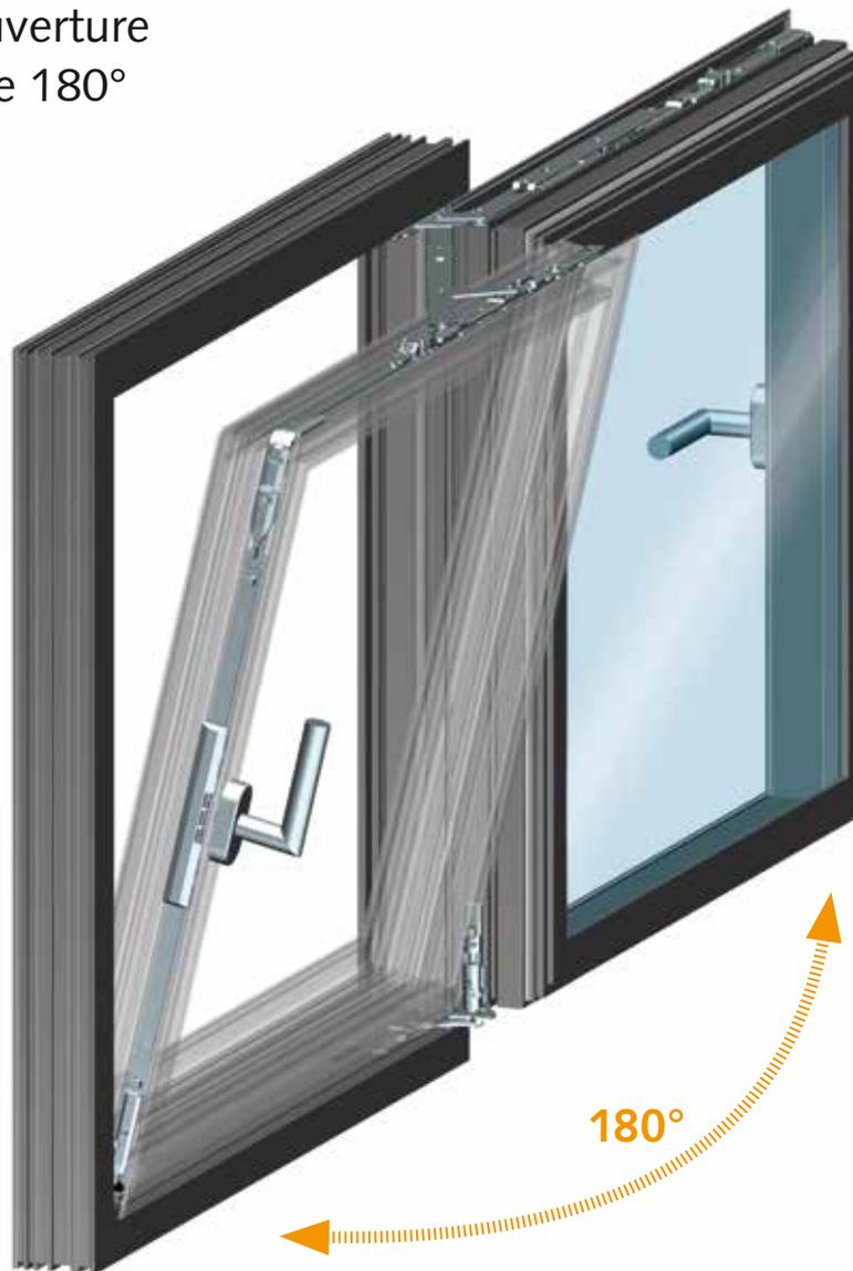
La nouvelle ferrure invisible est prévue pour un poids de châssis jusqu'à 130 kg, et adaptable à l'aide d'un kit sans difficulté particulière jusqu'à 170 kg.
