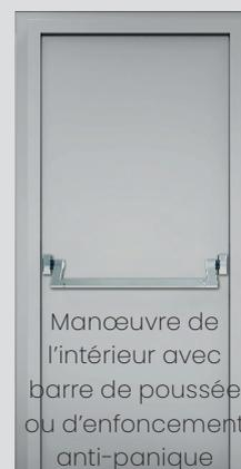
Les systèmes de fermeture contrôlés conformément aux normes EN 179 et EN 1125 satisfont à l'exigence selon laquelle les portes sur les voies et issues de secours doivent pouvoir s'ouvrir aisément à tout moment en un tour de main, de l'intérieur et sur toute leur largeur.
