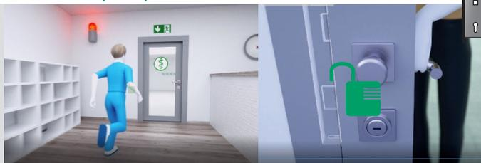
Dans une situation de panique, la porte est déverrouillée de l'intérieur en actionnant la béquille ou la ferrure anti-panique pour permettre le passage.
